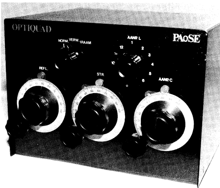
Fig. 12. De 14 antenntuners die bij de oorspronkelijke opzet van de DJ4VM-quad nodig zijn om op 7 banden te kunnen werken zijn bij de OPTIQUAD vervangen door dit ene kastje. Hiermee wordt de OPTIQUAD op elke gewenste frequentie in de zeven kortegolfbanden tussen 10 en 40 ingesteld op maximum signaal of op maximale voor/achter-verhouding. Dat gebeurt voor reflector en straler met de linker en middelste knop op de onderste rij. Met de rechter knop en de schakelaar rechtsboven wordt de belasting van de zender op 50 \Omega ingesteld. De knop linksboven staat bij normaal gebruik in de stand "NORM". In de stand "VERW" wisselen reflector en straler van rol en keert de stralingsrichting van de antenne om. In de stand "1 RAAM" werkt alleen de straler, bij proeven wel eens gemakkelijk (foto: PAoSE).
